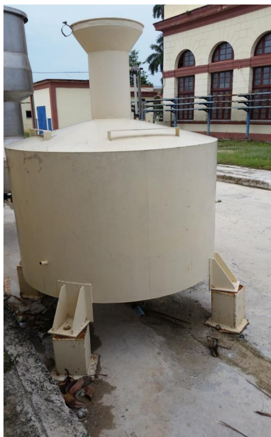
Fig. 2 Recipiente patrón de 2500 L, clase de exactitud 0,1 %
