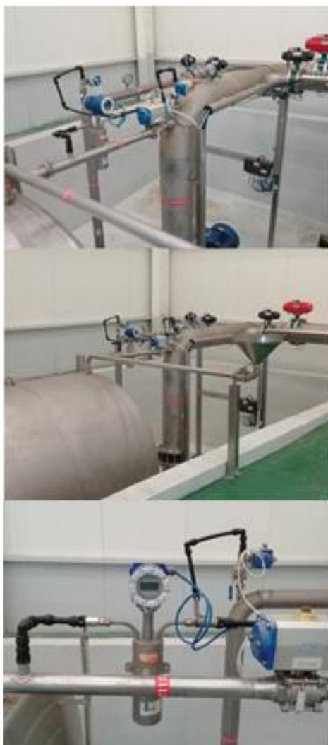
Figura 5. Vista del densímetro oscilatorio conectado en línea en la instalación de flujo de combustible del LCPC de Tecnomática.
