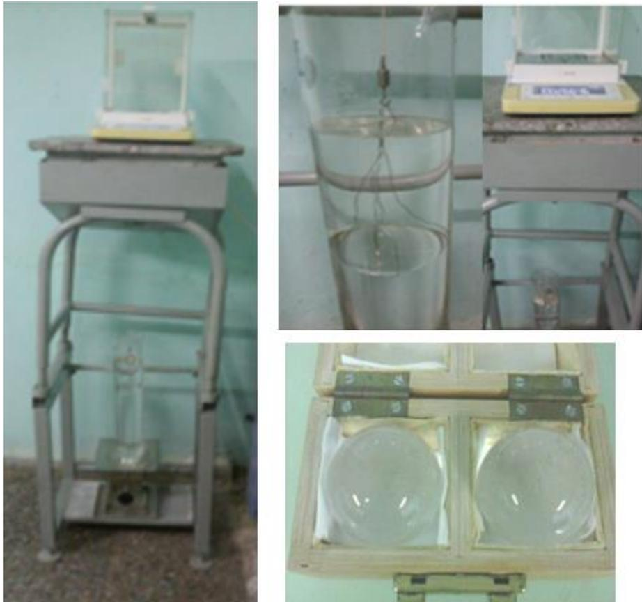
Figura 6. Maqueta funcional del Laboratorio de Densidad del INIMET para medir con las esferas de ULE.
