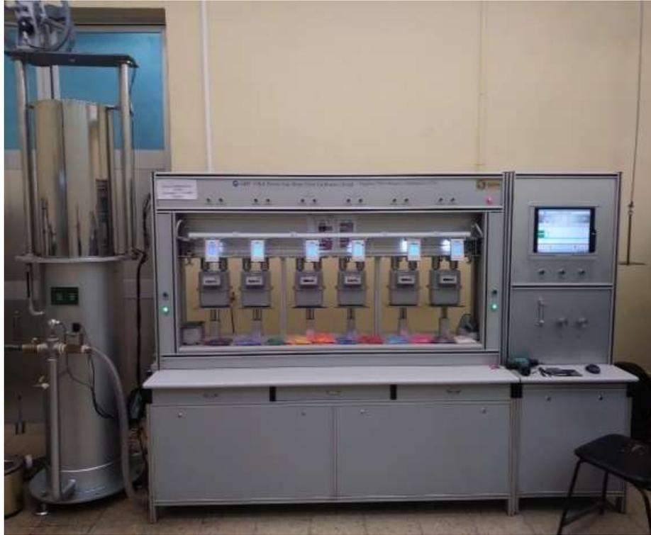
**Figura 4. Campana gasométrica LJQ-100 y contadores domésticos de gas.**
