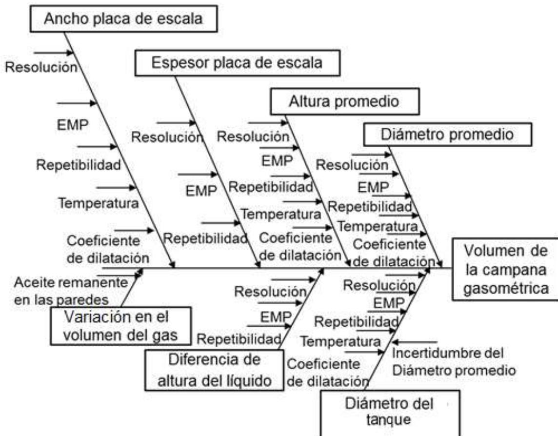
**Figura 5. Diagrama de causa y efecto de las variables que influyen en la estimación de la incertidumbre del volumen de la campana gasométrica.**
