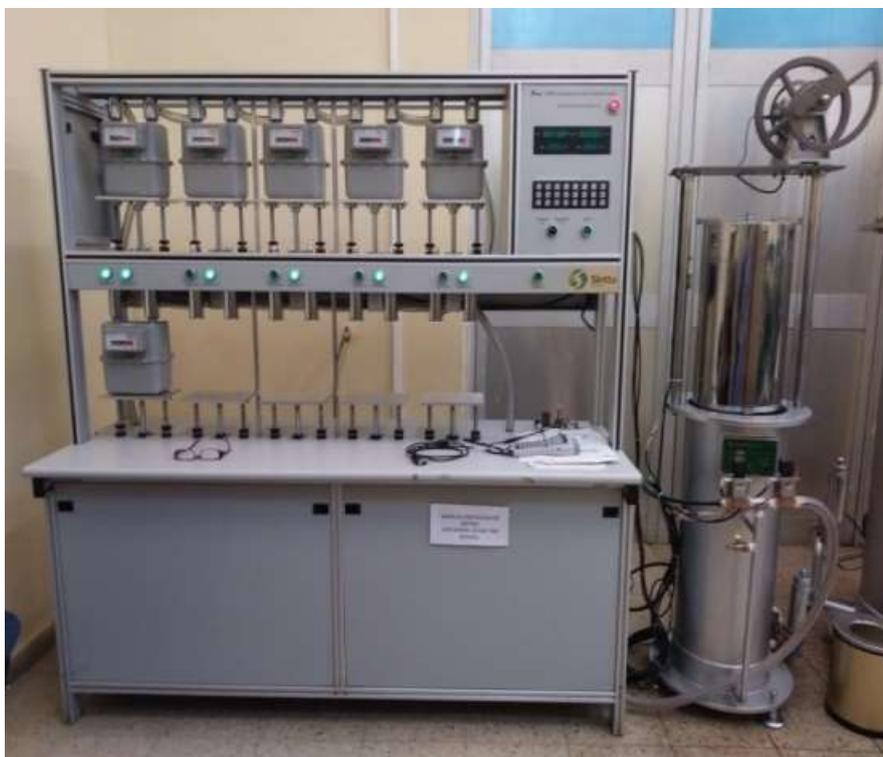
**Figura 3. Campana gasométrica LJQ-20 y contadores domésticos de gas**
